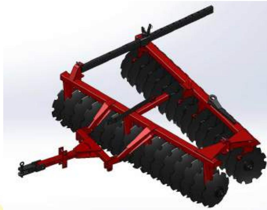
Grade com cabeçalho articulado para modo de transporte nos 3 pontos do trator. Ao lado cabeçalho na posição de trabalho para ser acoplado na barra de tração do trator.
