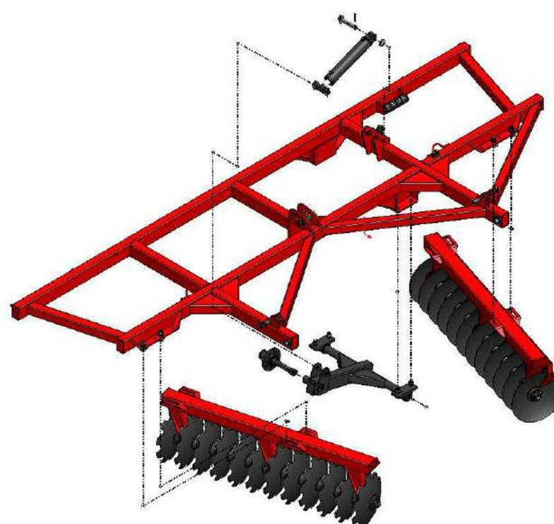
Montagem do quadro central com os quadros laterais e com o cabeçalho. A montagem de todos os demais componentes deverá ser realizado nesse momento também.
