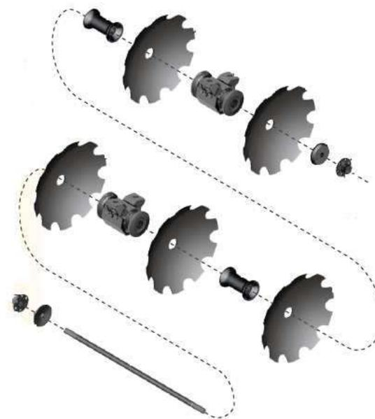
1- Montar o eixo com a porca e a arruela de encosto em uma das extremidades, apertar toda a porca e desrosquear três voltas, travar a porca com os parafusos na arruela de encosto. Seguir a montagem com o disco, posteriormente o mancal, depois outro discos, separadores até o montagem completa da seção de
