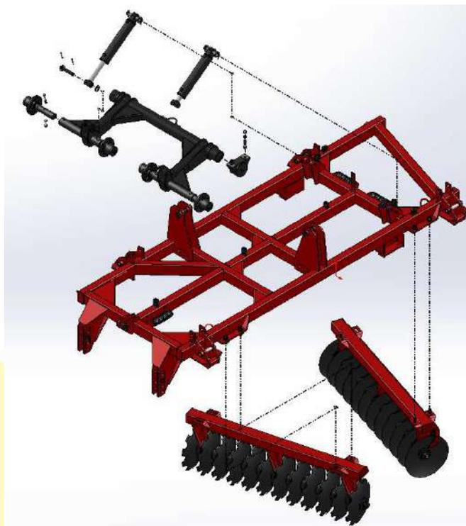
Montagem do quadro esquerdo e direito com os chassis dianteiro e traseiro do conjunto de discos e o sistema de rodeiros com o cilindro hidráulico.
