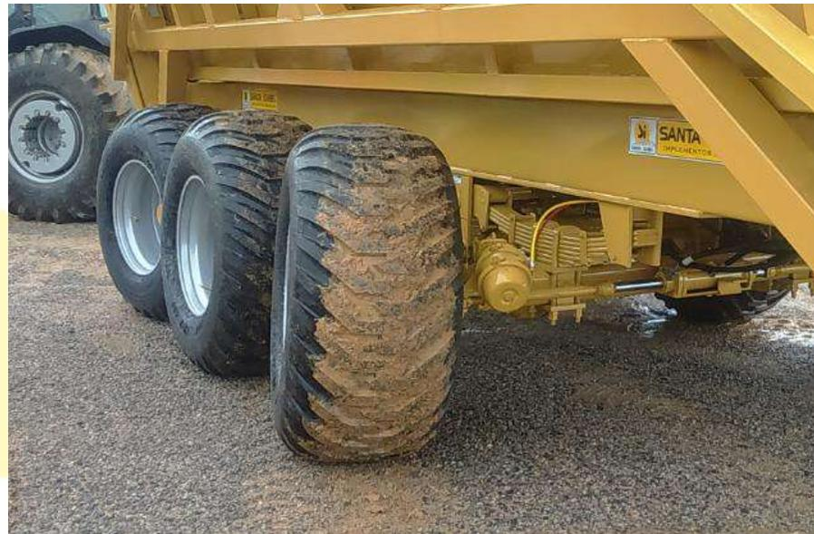
Jamais manobre o transbordo com os pneus travados, avarias irreversíveis podem acontecer no sistema de rodagem do equipamento, sendo essa operação não passível de garantia.
