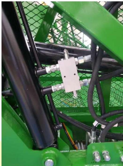
Válvula de segurança instalada nos cilindros de levante dos transbordos.
