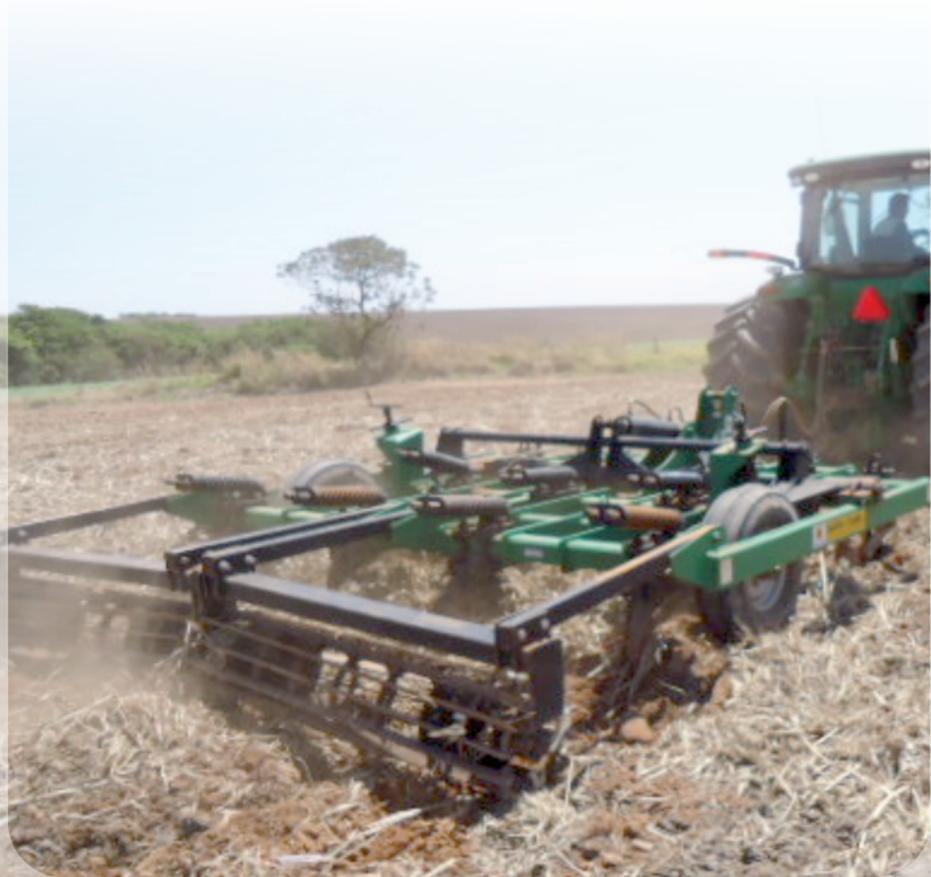
O **SHSI** é projetado para o preparo de solo de subsolagem e escarificação em áreas de baixa compactação.
