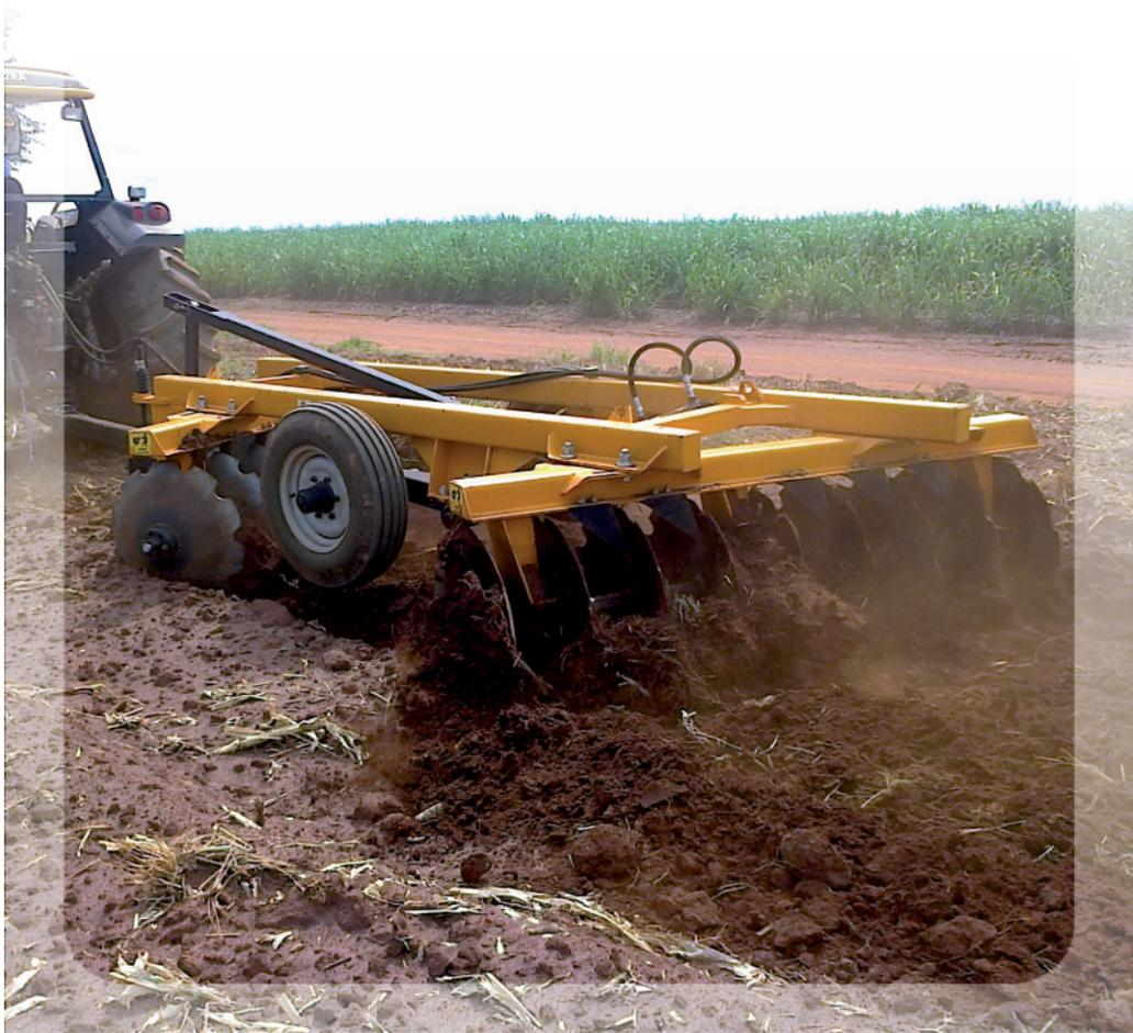
A **GNL** é dotada por dois chassis, dianteiro e traseiro com articulação lateral de regulagem mecânica variada para melhor se adaptar as condições de solo de cada cliente.
